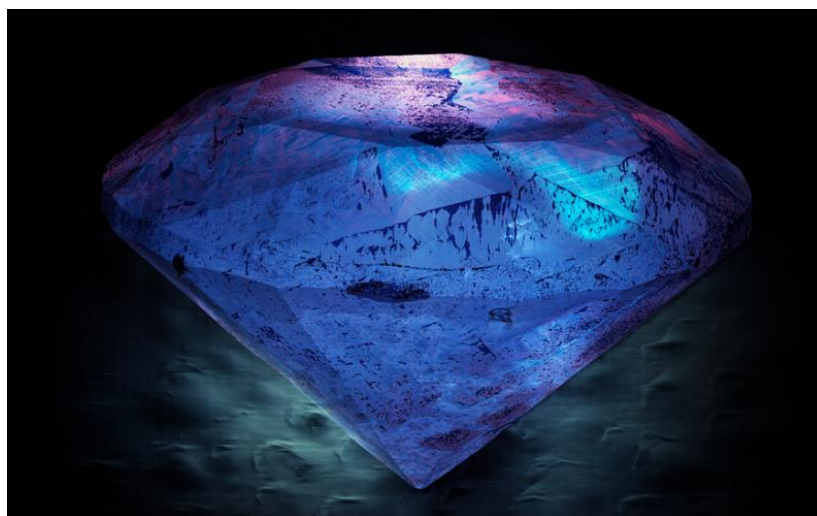
شکل ۴. نمایش پدیده‌ی کاتد تابناکی در الماس تراش‌خورده، ثبت‌شده توسط میکروسکوپ الکترونی با میدان دید 3/45 میلی‌متر که نواحی تابناک ناشی از برانگیختگی الکترونی را نشان می‌دهد.
