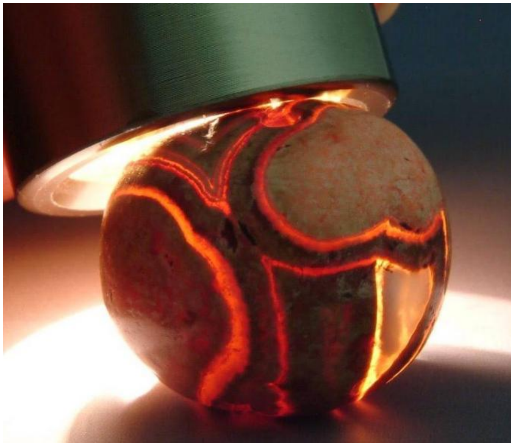
شکل ۲. تعیین قدمت سفالینه‌ها با روش تابناکی گرمایی.
