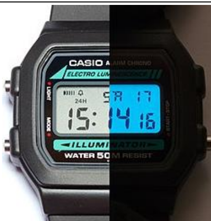
شکل ۳. ساعت دیجیتال LCD کاسیو با نور پس‌زمینه الکترولومینسنت: نمونه‌ای از نمایشگرهای کریستال مایع که از تابش الکترولومینسنت برای روشنایی یکنواخت در محیط‌های تاریک استفاده می‌کند.
