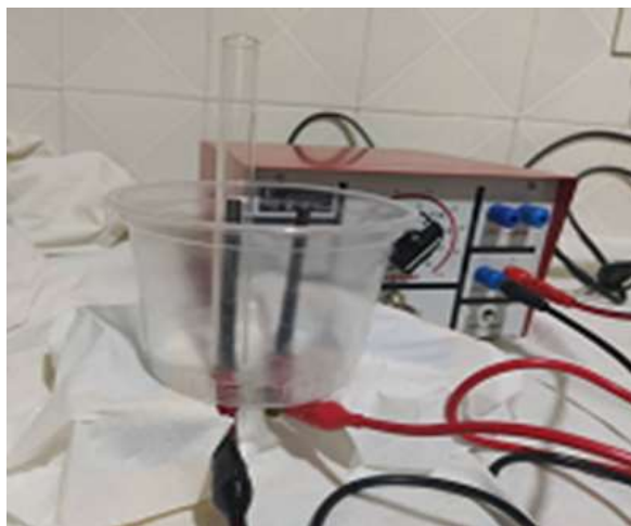
شکل ۳- دستگاه الکترولیز دست‌ساز
